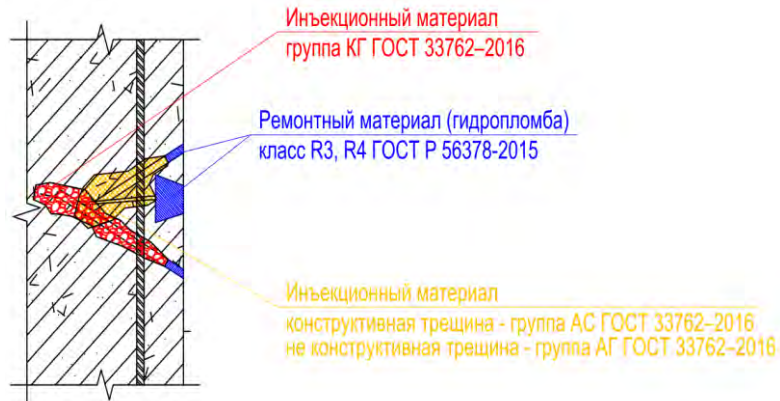
Рис. 2. Схема ремонта конструктивных и неконструктивных трещин с проявлениями фильтраций
